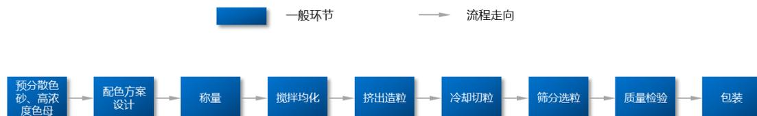
以上两种工艺是按颜色黄、橙、红、绿、蓝、特殊效果颜色等建立多条生产线，根据不同颜料的化学结构特性，选择最优设备生产高浓度与分散色砂、色母粒，最后再根据客户订货要求，通过智能化配色系统测色，采用高浓度预分散色砂、色母粒，按配方搅拌均匀，挤出造粒，装袋。
