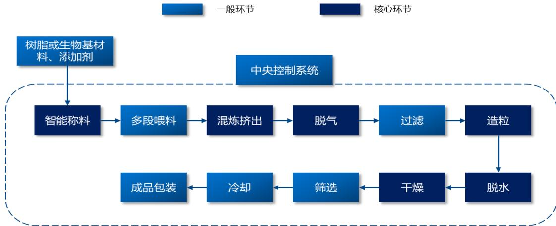
通过上述生产工艺流程图可知，黑色母粒和白色母粒主要采用连续式混炼工艺生产，确保高速挤出过程中产生的内聚热不会影响色粉的着色强度和遮盖力；而彩色母粒生产需要根据各种有机颜料的不同化学结构来调整工序进行灵活处理，例如根据颜料耐温性的差异采用间歇式混炼或者连续式混炼，以及根据颜料粒径不同决定是否加入研磨分散工序，通过上述灵活工序的处理达到既分散颜料又保护颜料的作用。功能母粒与生物基可降解母粒的生产工艺流程基本相似，但与白色母粒和黑色母粒在喂料、脱气等生产工艺环节存在不同，其余混炼挤出、干燥、造粒等生产工艺环节基本相同。
