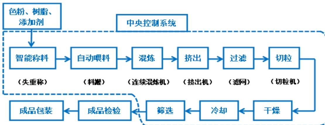
上述工艺主要以树脂为载体、添加钛白粉或者炭黑，利用连续混炼机生产白色母粒或者利用下落式密炼机/密炼机+挤出机生产黑色母粒。
